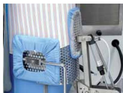
El carro tensor de 5 palas garantiza el planchado uniforme del borde, sin fruncidos ni rayas horizontales. Se puede programar el número y la intensidad de los movimientos de tensado vertical que el carro realiza durante el ciclo. En cambio, si la camisa es delicada, los tensores se pueden desactivar completamente pulsando una tecla en la consola.
