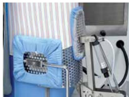
Il carro tensore a 5 pale garantisce la stiratura uniforme dell'orlo, senza arricciature né righe orizzontali. È possibile programmare il numero e l'intensità dei movimenti di tensionamento verticale che il carro compie durante il ciclo. Se la camicia è delicata, invece, i tensionamenti si possono escludere completamente alla sola pressione di un tasto sulla consolle.
