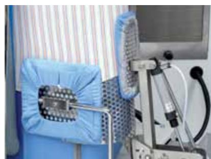
Le chariot de tensions à 5 pales garantit le repassage uniforme de l'ourlet, sans fronçures ni lignes horizontales. Il est possible de programmer le nombre de mouvements et leur intensité de mise en tension verticale que le chariot accomplit pendant le cycle. Si la chemise est délicate, en revanche, les mises en tension peuvent être complètement exclues par la simple pression d'une touche sur la console.
