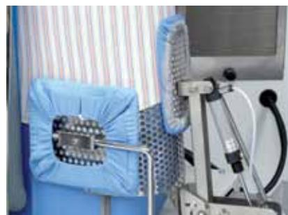
Der Streckschlitten mit 5 Andruckpatschen garantiert das gleichmäßige Bügeln des Saumes ohne Kräuselungen oder waagerechte Linien. Anzahl und Stärke der vertikalen Streckbewegungen, die der Schlitten während des Zyklus ausführt, sind programmierbar. Wenn das Hemd dagegen aus einem empfindlichen Gewebe ist, lassen sich die Streckbewegungen durch einfaches Drücken einer Taste am Steuerpanel ganz ausschließen.
