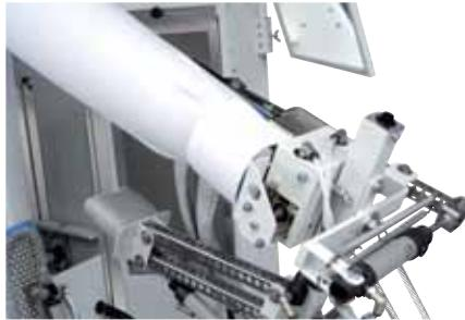
Die Form der Manschettenklammer wurde so entwickelt, dass sie die Rundung der Manschette beibehält.
