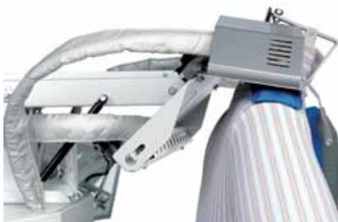
Die Presse ist gepolstert, daher trocknet sie die obere Naht, ohne Glanzspuren zu hinterlassen. Ein starker Heißluftstrahl trocknet die Naht der Passe, ohne sie zu pressen. So bleiben keine Glanzspuren zurück und eventuell vorhandene Falten oder Verzierungen werden nicht beschädigt. Für ein Armloch ohne Knitterfalten ist die Schulterbreite je nach Hemdengröße verstellbar und lässt sich auch während des Zyklus jederzeit korrigieren.
