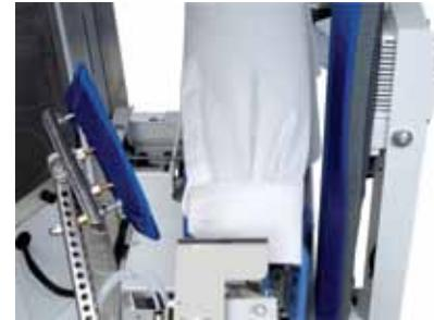
Die oberen Ärmelfalten werden nicht einfach gepresst, sondern weich wie von Hand gebügelt.
